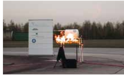
Abbildung 3: In hellem Tageslicht kaum sichtbare Wasserstoffflamme oben rechts
